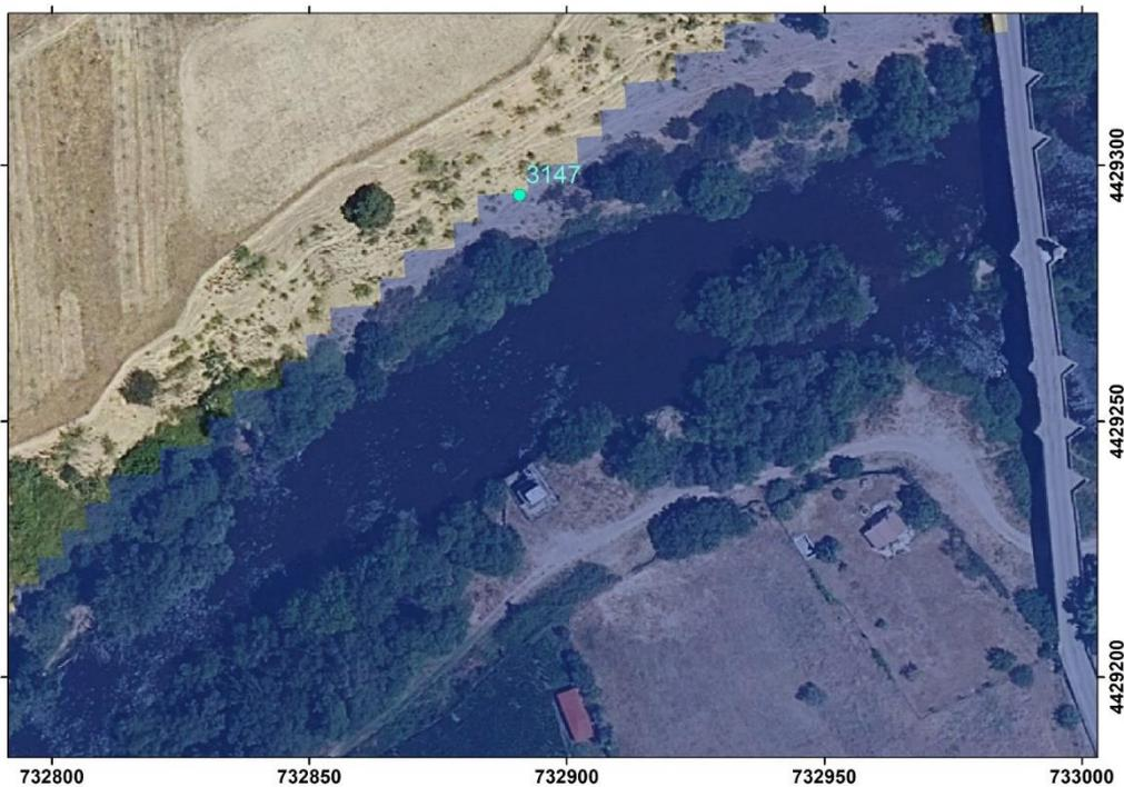
Figura 13. Vista aérea sobre la estación de aforo 3147 y con la zona inundable para un periodo de retorno de 5 años.
