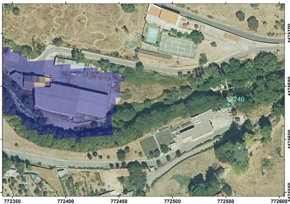
Figura 27. Vista aérea sobre la estación de aforo 3240 y con la zona inundable para un periodo de retorno de 5 años.
