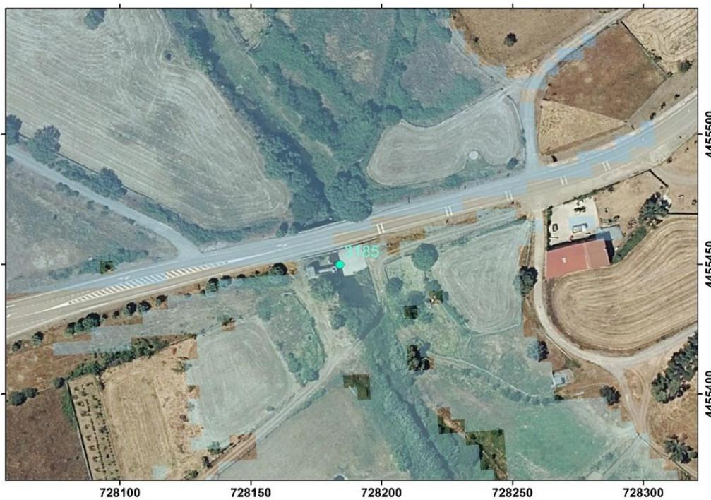
Figura 21. Vista aérea sobre la estación de aforo 3185 y con la zona inundable para un periodo de retorno de 5 años.
