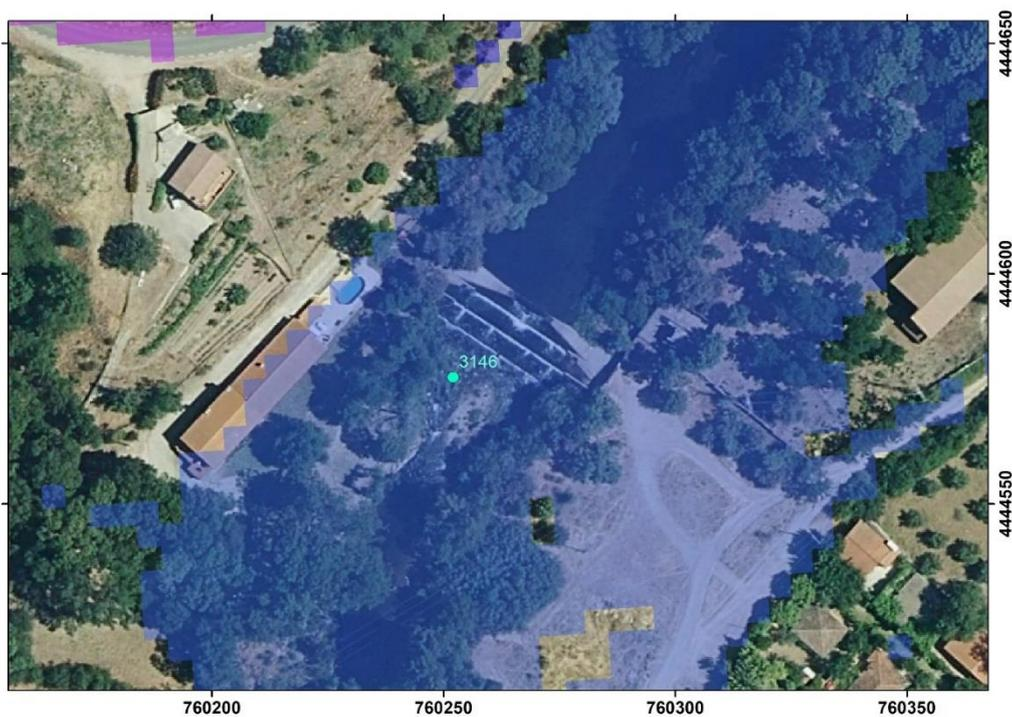
Figura 11. Vista aérea sobre la estación de aforo 3146 y con la zona inundable para un periodo de retorno de 5 años.
