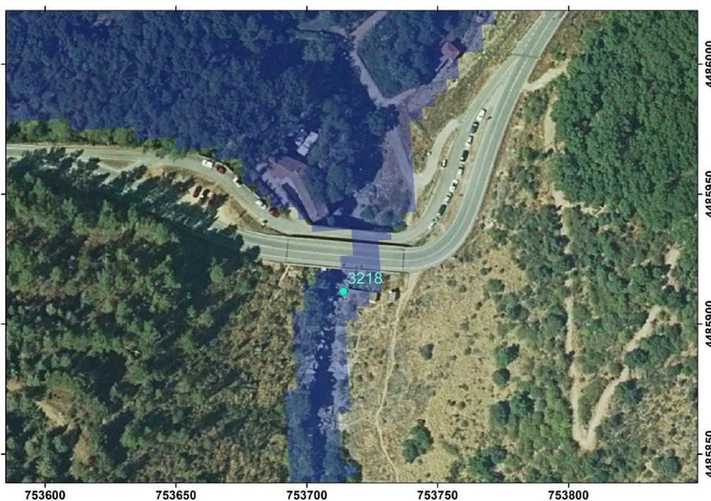
Figura 25. Vista aérea sobre la estación de aforo 3218 y con la zona inundable para un periodo de retorno de 5 años.
